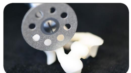
Mit starren Diamantscheiben, z.B. 918D, die mit Naturdiamantpulver beschichtet sind, lassen sich Gusskanäle und Halterungen effizient abtrennen und separieren.
